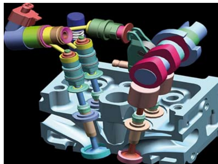
El Sistema Multi Air es otro dispositivo producto de la Tecnología de Fiat
