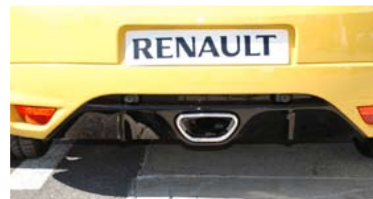
El escape colocado en el centro del difusor.
