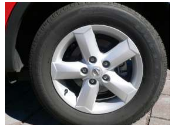
Llantas de aleación de 16" con neumáticos 215/65
