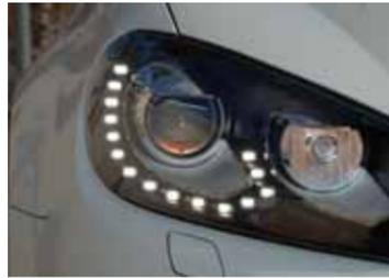
Diodos LED para iluminación diurna.
