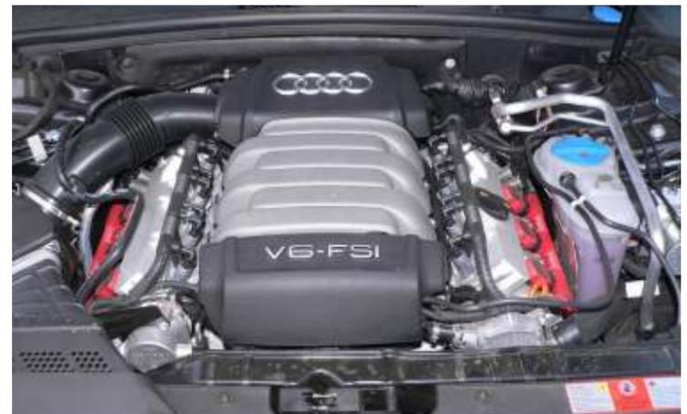
El A4 que probamos tenía motor V6-FSI con 3200cc y 265CV
