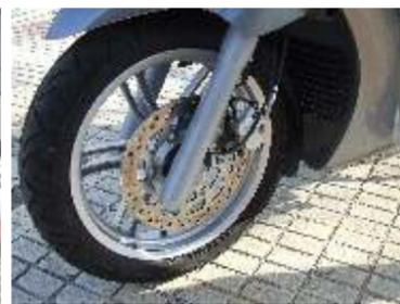
Disco de 270mm y llanta delantera de 16"
