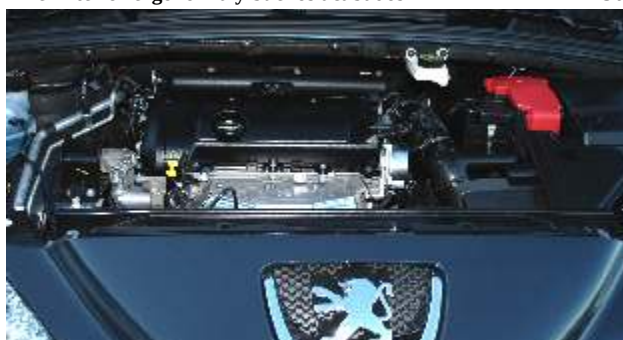
El motor de gasolina 1.6 VTI de 120 CV
