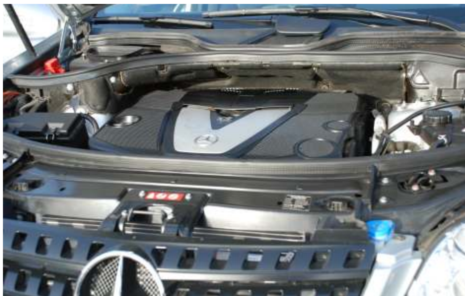
El motor en V6, con 3.498 cc, proporciona 272 CV y se comporta con una increíble soltura.
